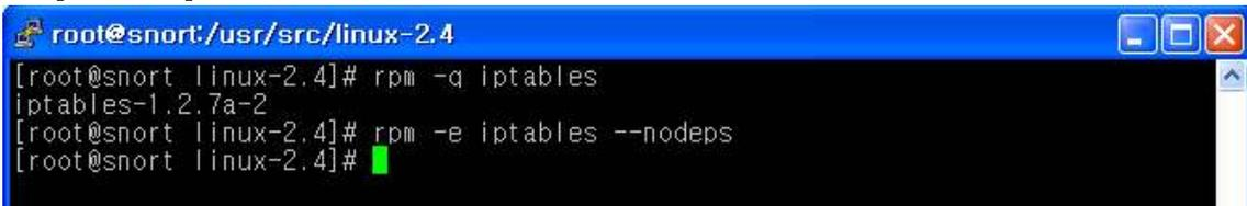
그림 3-13 iptables rpm 제거
