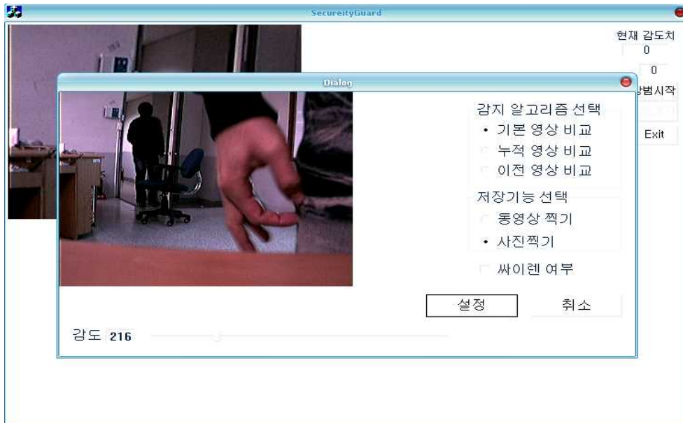
[그림 5.] 기본영상비교 알고리즘을 이용하여 캠에 화면에 찍히는 화면 설정 및 감도, 사진 찍기, 사이렌 여부 설정화면
