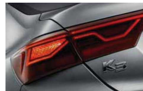
급제동 경고 시스템 (ESS) 차량 급제동 시 제동등과 비상등을 점멸시켜 후방차량에 위급상황을 경고해 주는 안전 보조장치입니다.
