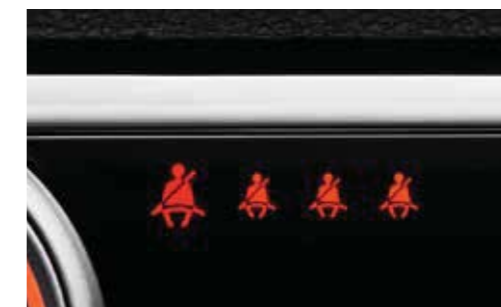
전좌석 시트 안전벨트 경고장치 안전벨트가 체결되지 않았을 경우, 경고등 혹은 경고음으로 승객에게 경고하여 줍니다. ※ 운전석 경고등: 클러스터에 표시 / 그 외 좌석 경고등: 센터페시아에 표시
